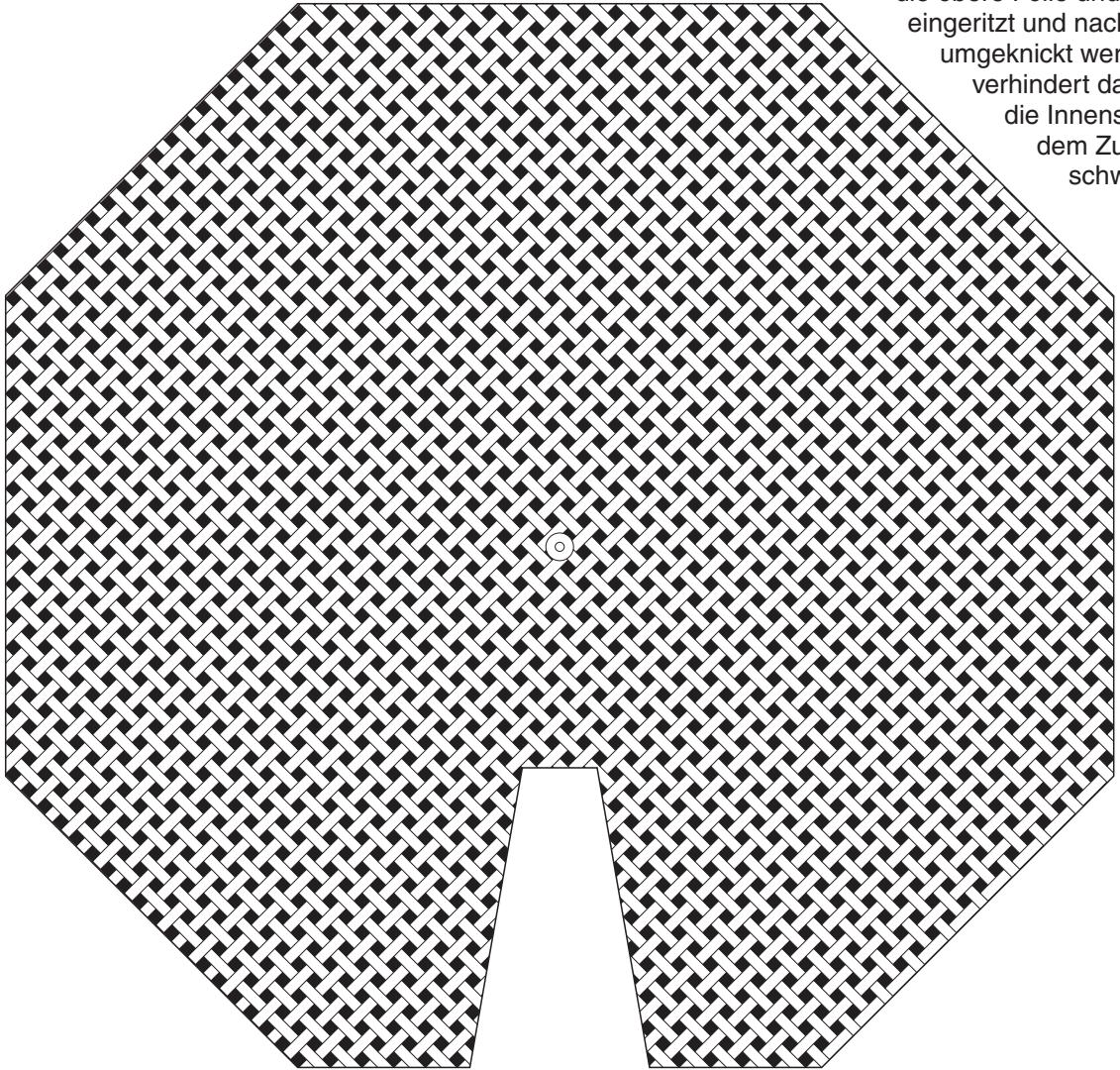
Die acht kleinen Stege an der oberen Hüllenhälfte sollten nach dem Laminieren mit einem scharfen Teppichmesser durch die obere Folie und das Papier eingeritzt und nach innen umgeknickt werden. Man verhindert damit, dass sich die Innenscheibe nach dem Zusammenbau nur schwer drehen lässt.
