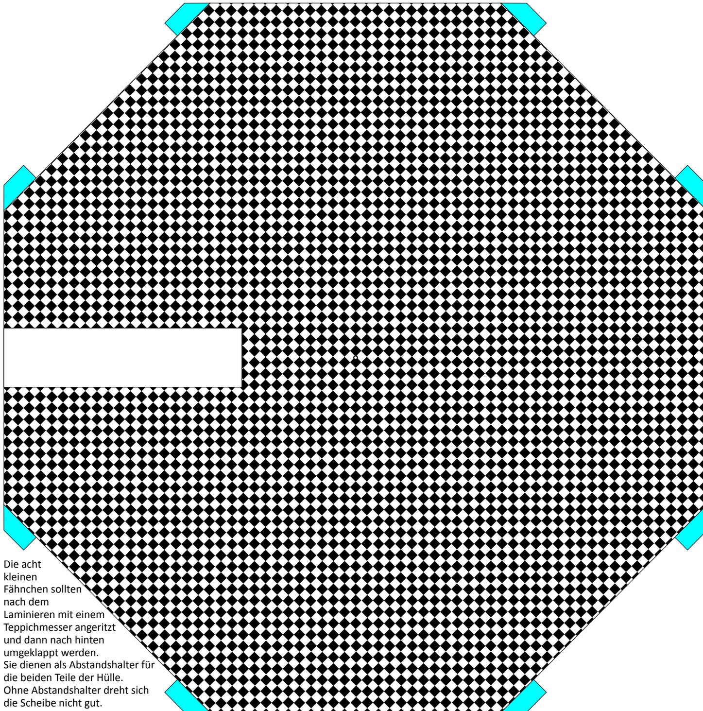
Die acht kleinen Fähnchen sollten nach dem Laminieren mit einem Teppichmesser angeritzt und dann nach hinten umgeklappt werden. Sie dienen als Abstandshalter für die beiden Teile der Hülle. Ohne Abstandshalter dreht sich die Scheibe nicht gut.
